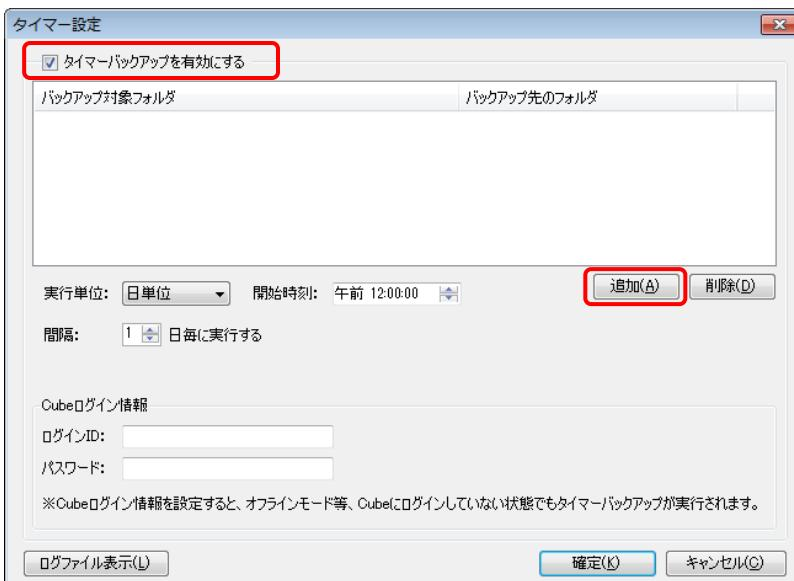
3. バックアップ対象のフォルダ、バックアップ先のフォルダを設定します。
